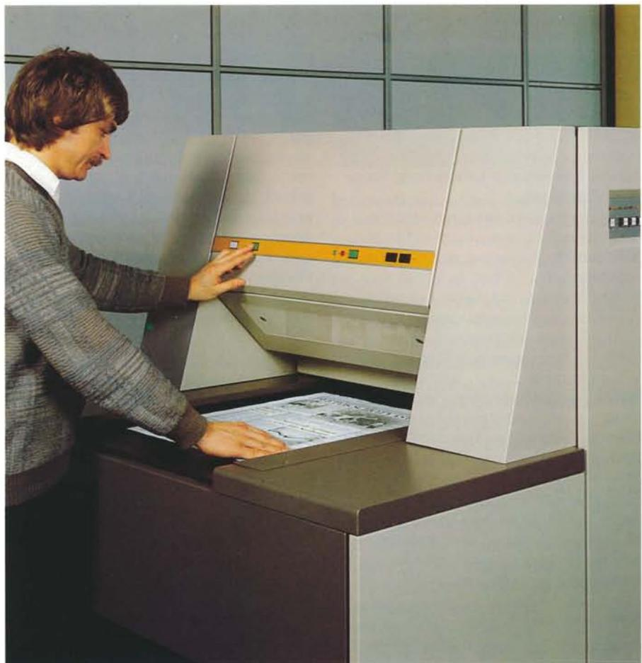
Das neue Pressfax-Flachbettgerät von Hell.
