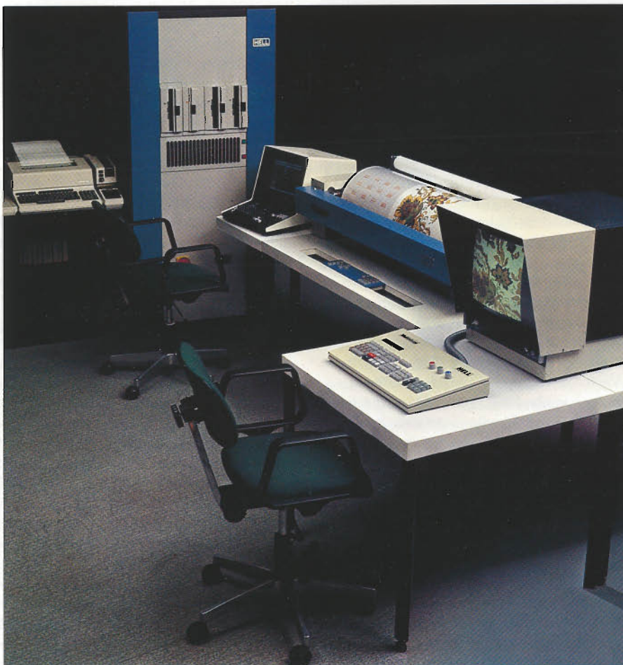
Elektronik bestimmt das Herstellen von Jacquardkarten. Das Bild zeigt das komplette Patro-System mit Patrocom, Patroscan und Patroskop.
