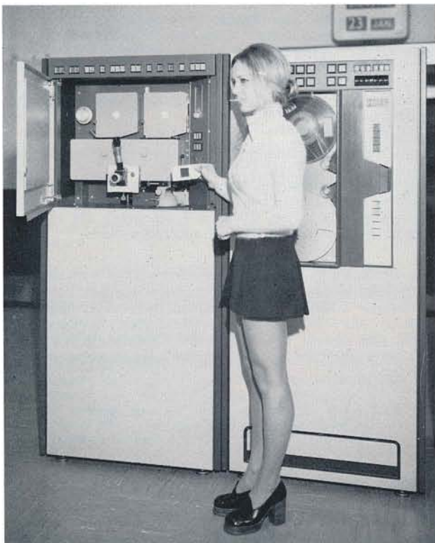
Bild 2. Dicom 2010 geöffnet. Oben ist der Kamerateil mit der Formularprojektion, unten befindet sich der Aufzeichnungsteil, rechts neben dem Dicom die Magnetbandstation ME 2002.
