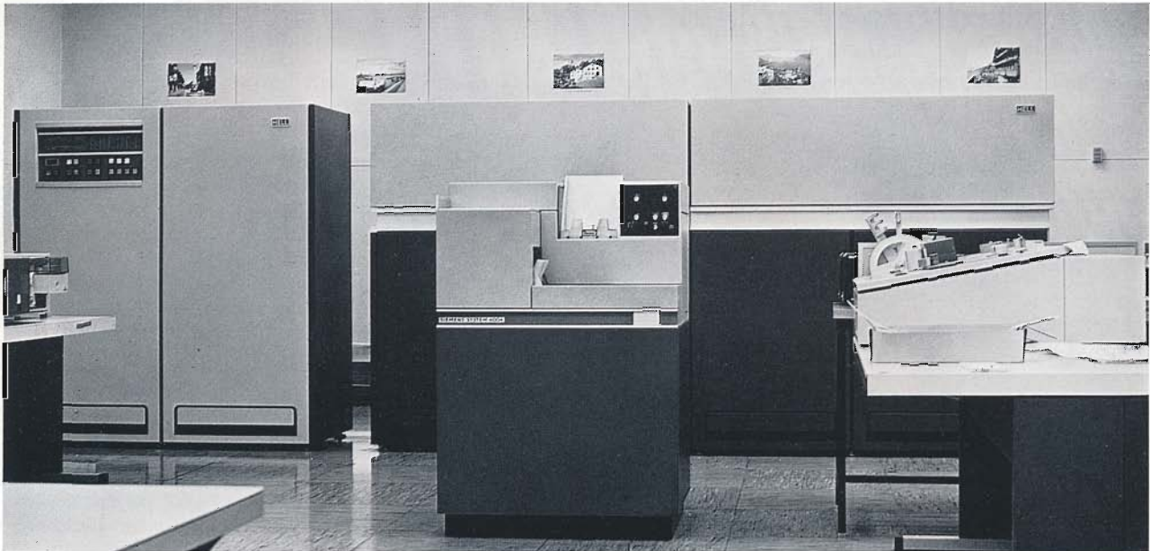
Bild 2 Die Digiset-Anlage 50 T 21 mit Zentralsteuereinheit, Schreib- und Aufzeichnungseinheit (von links nach rechts) sowie im Vordergrund der Lochkartenleser und Lochstreifenstanzer.
