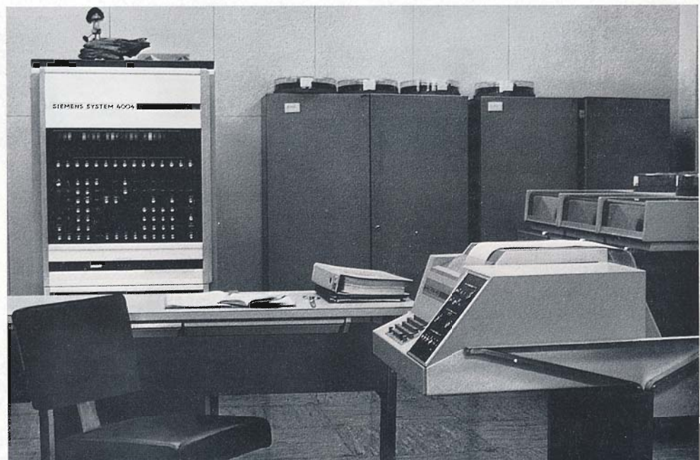
Auf dem Bild befindet sich die Zentraleinheit (links), drei Plattenspeicher (hinten rechts) und der Bedienungsblattschreiber (im Vordergrund).
