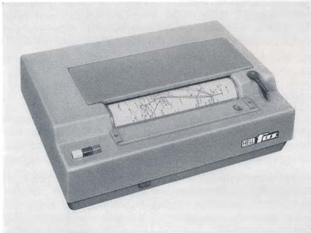
Ansicht des neuen Hellfax-Transceiver HF 146, mit dem Faksimile-Übertragungen bis zum Format A 4 möglich sind.
