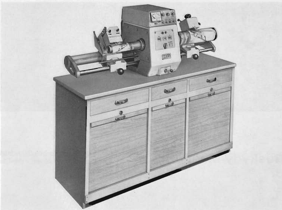
Klischograph K 155 zum Gravieren von Klischees und Folien für den Zeitungs-, Buch- und Offsetdruck.
