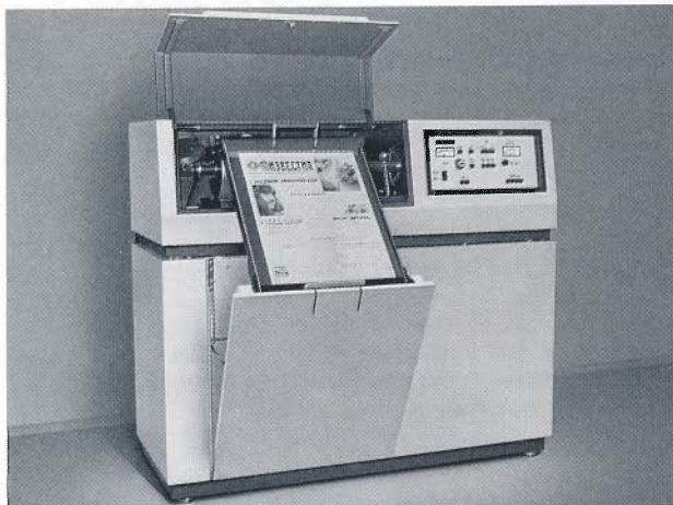
Ansicht des Pressfax-Transceiver P 912. Das Gerät ist zum Aufspannen des Abtastoriginals geöffnet.
