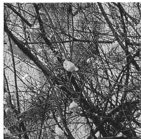
Bild 5: Übertriebene Anwendung des „Vorlaufeffektes“ (Feindetail). Man achte auf die hellen Ränder neben den dunklen Ästen in der Gravurrichtung! Ausschnittsvergrößerung aus einer Gravur im 60er Raster. (Über Scotch-Print-Abzug zum Negativ, Projektion zum 48er Raster, Dow-Ätzung)
