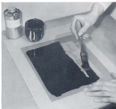
Bild 1–3: Umfärben zum Negativ. – Bild 1 (links): Das auf Litarfolie gravierte Rasterdiapositiv wird mit Umkehrlack eingefärbt. – Bild 2 (mitte): Mit dem Positiventferner wird die orangefarbige Schicht entfernt. – Bild 3 (rechts): Das tonwertrichtige Rasternegativ ist kopierfähig für den Offsetdruck.
