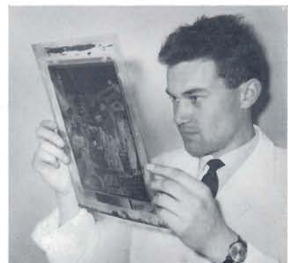
Bild 1–3: Umfärben zum Negativ. – Bild 1 (links): Das auf Litarfolie gravierte Rasterdiapositiv wird mit Umkehrlack eingefärbt. – Bild 2 (mitte): Mit dem Positiventferner wird die orangefarbige Schicht entfernt. – Bild 3 (rechts): Das tonwertrichtige Rasternegativ ist kopierfähig für den Offsetdruck.
