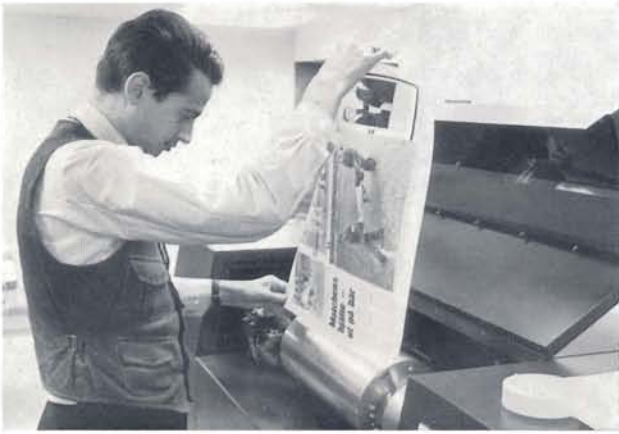
1 Die Sendevorlage wird auf die Trommel des Gebers gespannt.
