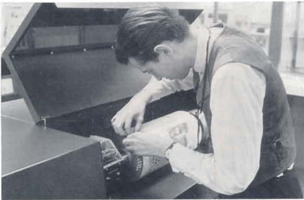
2 Die Sendevorlage wird mit beidseitig klebendem Film- band befestigt.
