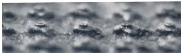
Bild 4 Vom Chemigraphen (in guter Absicht) eingewalztes und tiefergeätztes Klischee. Die Punkttiefwalzung war zu stark, so daß eine Schulter entstand. Die geringe Steilheit oberhalb der Schulter blieb unverändert, die größere unterhalb der Schulter ist nutzlos.
