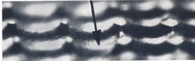
Bild 2 Der geätzte Punkt steht steil und randscharf. Hohe Auflage und gleichmäßiger von der Druckspannung wenig abhängiger Ausdruck sind gewährleistet. Ätzzeit ca. 40 Sekunden. Ätzvorgang dreimal unterbrochen und mit Plüsch abgerieben. Keine Deckarbeit, kein manueller Eingriff.
