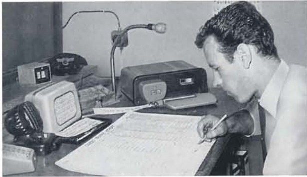
In der Frachtabteilung der Deutschen Lufthansa – FRECO – legt der Frachtkoordinator die Zuladung von Post und Fracht für jeden Flug fest. Der ZETFAX-Geber HT 206 überträgt diese Daten schnell und fehlerfrei.
