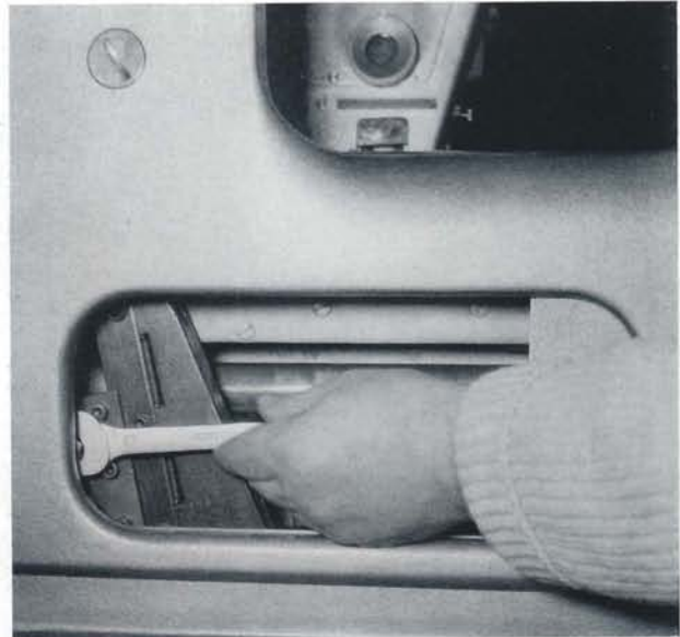
Mit dem Maulschlüssel wird die in ungünstiger Stellung stehende Klemmschraube gelöst. So kann jetzt der Bildtisch direkt auf den Bildanfang gefahren werden.
