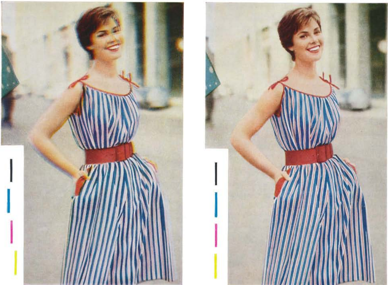
Bild 2 Links: Verschiebung der Farbanteile eines Vierfarbendrucks durch Längsregisterfehler; rechts: einwandfreie Wiedergabe.
