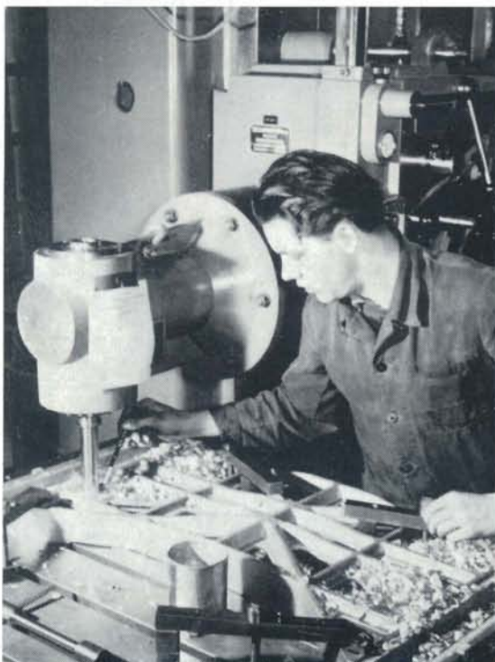
Das über die Polaroidkamera vergrößerte Bild graviert auf dem Klischograph.
