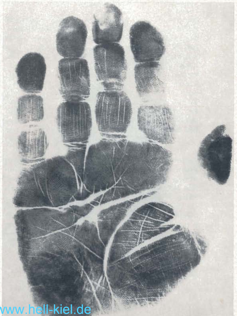
Abb. 3 Mit Telebildgerät übertragener Handabdruck auf dem Klischograph graviert mit 48er Raster
