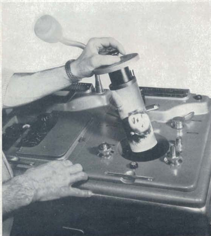
Abb. 1 Einsetzen der auswechselbaren Trommel in den Sender
