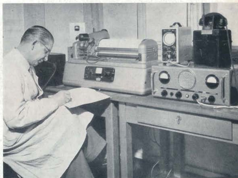
Zentrale Wetterkartensendestelle in der Wetternachrichtenzentrale Frankfurt am Main. Auf dem Tisch ein Wetterkartensender WF 104 und ein Langwellen-Kontrollempfänger.
