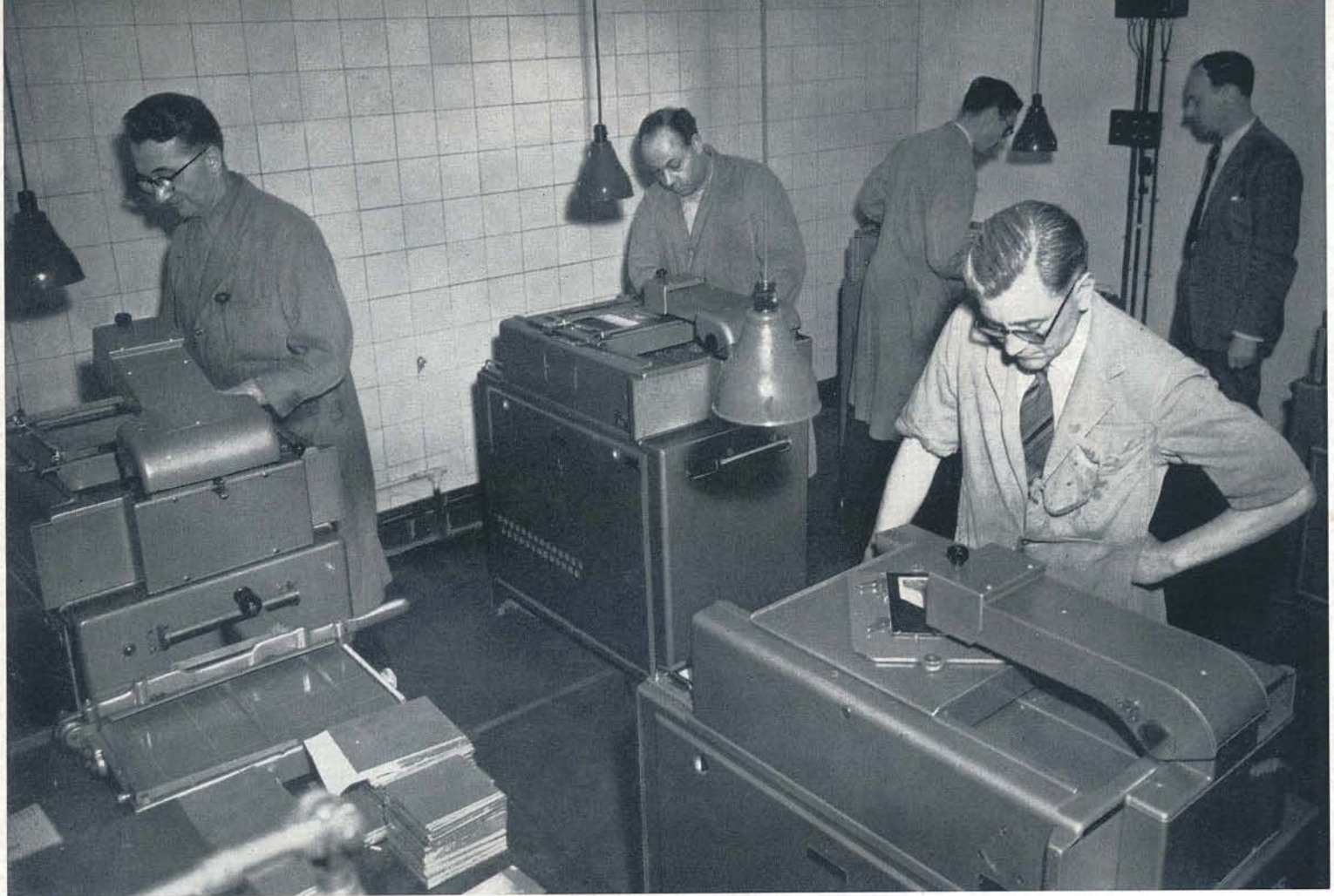
Der Klischographenraum bei der «TIMES». Fünf Klischographen, davon zwei für Strich und drei für Raster, sorgen hier für die anerkannt gute Bildqualität dieser Zeitung.
