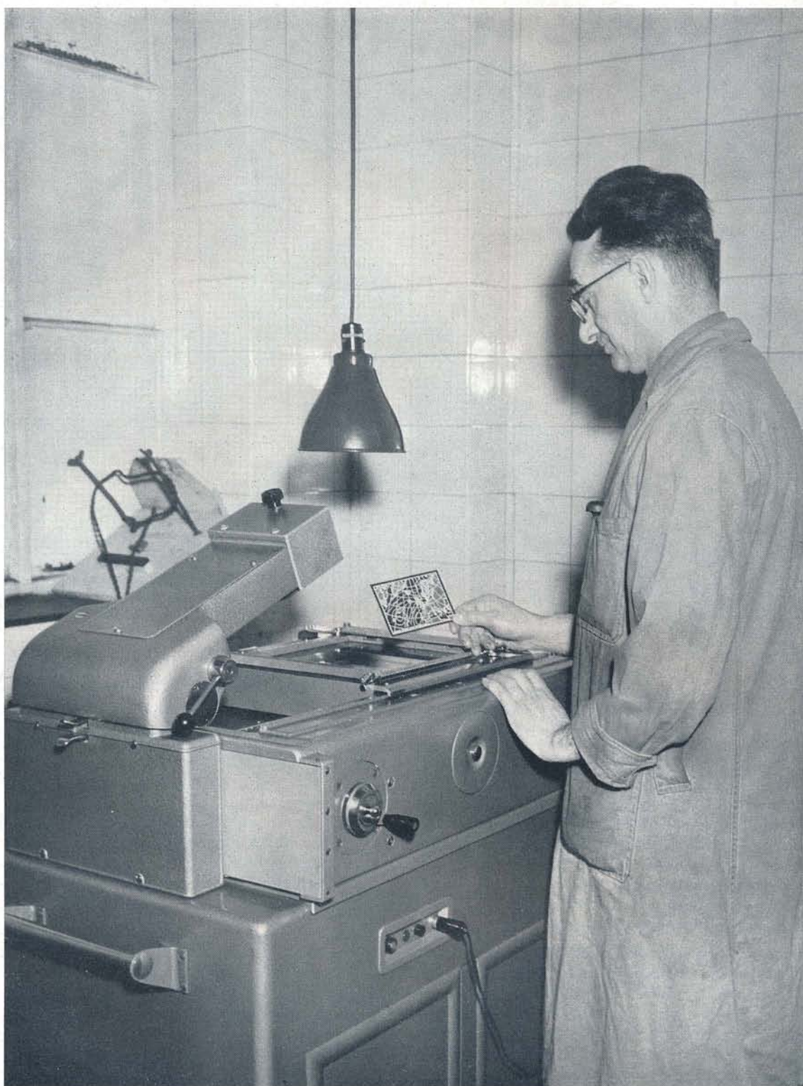
Hier wird das Papiernegativ geprüft und dann entschieden, in welchem Winkel am besten einzulegen ist, denn: richtiges Einlegen verbürgt gute Ergebnisse.
