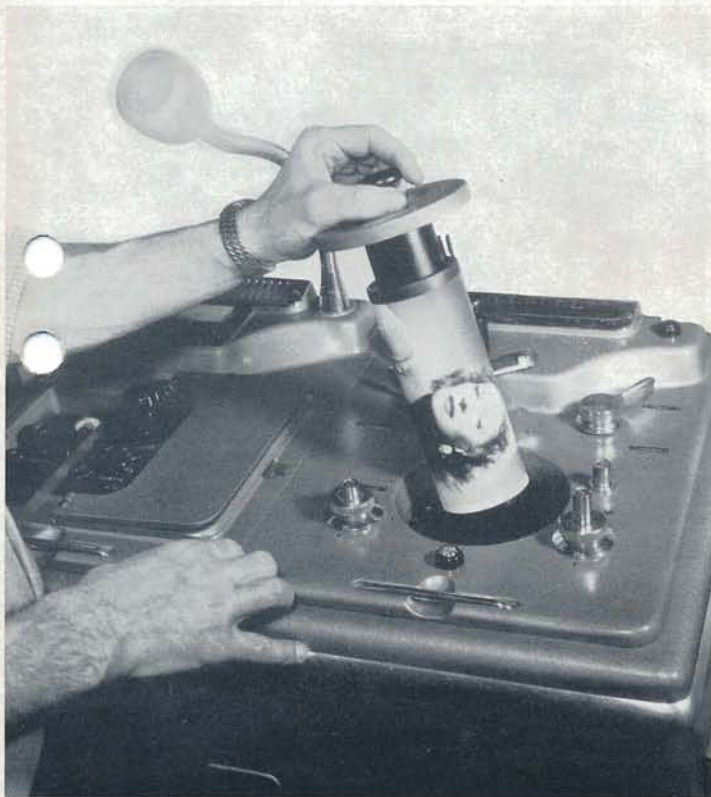
Abb. 1 Einsetzen der auswechselbaren Trommel in den Sender
