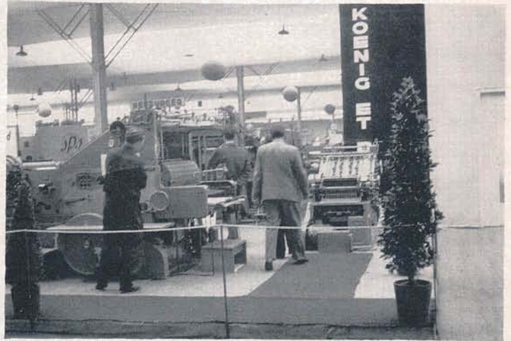
Aus der schönen Main-Metropole Würzburg hatte die Schnellpressenfabrik Koenig & Bauer ihre Erzeugnisse nach Paris geschafft. Hier sieht man die Zweitourenmaschine „Sturmvogel“ mit Groß-Stapel-Kettenauslage. Durch den Einbau eines Rundeindruckwerkes ermöglicht diese Maschine Mehrfarbendruck in einem einzigen Arbeitsgang.
