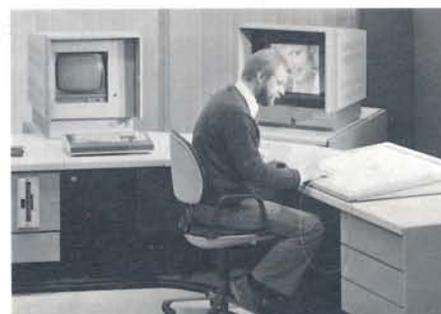
über seinen Farbmonitor die Einstellung des angeschlossenen Farbwechslers so simulieren kann, daß sie dem erzielbaren Druckergebnis entspricht. Auf diese Weise ist eine wirksame Kontrolle erreicht, durch die schon vorab Fehleinstellungen und Mißerfolge in der Reproduktion sicher vermieden werden können.
