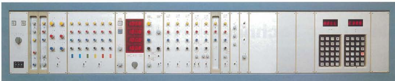
Der Farbrechner des Chromagraph 399 – das Bediensfeld für reprotechnische Einstellungen
