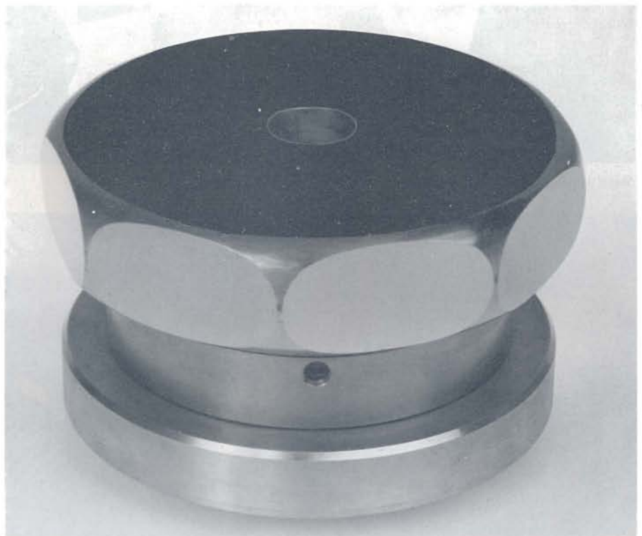
Der Drehspiegel im LS 210 lenkt den Laserstrahl immer über die volle Aufzeichnungsbreite von 473 mm. Bei einer Umdrehung des Spiegels werden acht Zeilen belichtet. Die einzelnen Spiegelflächen erreichen höchste optische Qualität. Genauigkeit: 1/10 der Lichtwellenlänge. Der Spiegel bewegt sich luftgelagert. Die Abstände zwischen den einzelnen Scanlinien ergeben sich durch gleichmäßige Bewegung des Aufzeichnungsmaterials.
