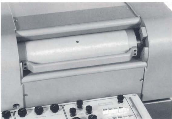
Tageslichtkassette des CHROMAGRAPH in eingekuppeltem Zustand
