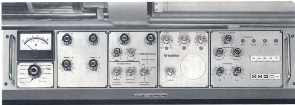
Das Bedienungspult des CHROMAGRAPH mit seinen übersichtlich angeordneten Reglern
