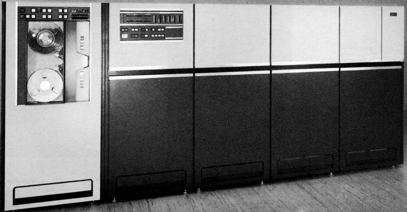
Ansicht einer Digiset-Lichtsetzanlage 40 T 1 mit Magnetband-Eingabeelement ME 2002
