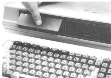
Mit der nebenstehenden Eingabefolge wird der Urlader in den Speicher geladen. Er identifiziert die Hardware des Sichtgerätes (große oder kleine Tastatur) und lädt dann das entsprechende SIPRO in den Speicher; dabei leuchtet die DISK-Lampe im Tastaturfeld auf. Das SIPRO wird sofort geladen, wenn keine DUST-Baugruppe im Gerät vorhanden ist oder das Gerät mit einer kleinen Tastatur ausgerüstet ist.
