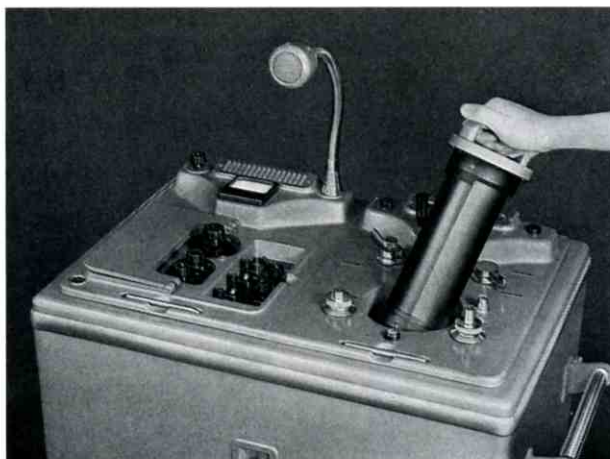
Einsetzen der Kassette in den TELEBILD-Empfänger
