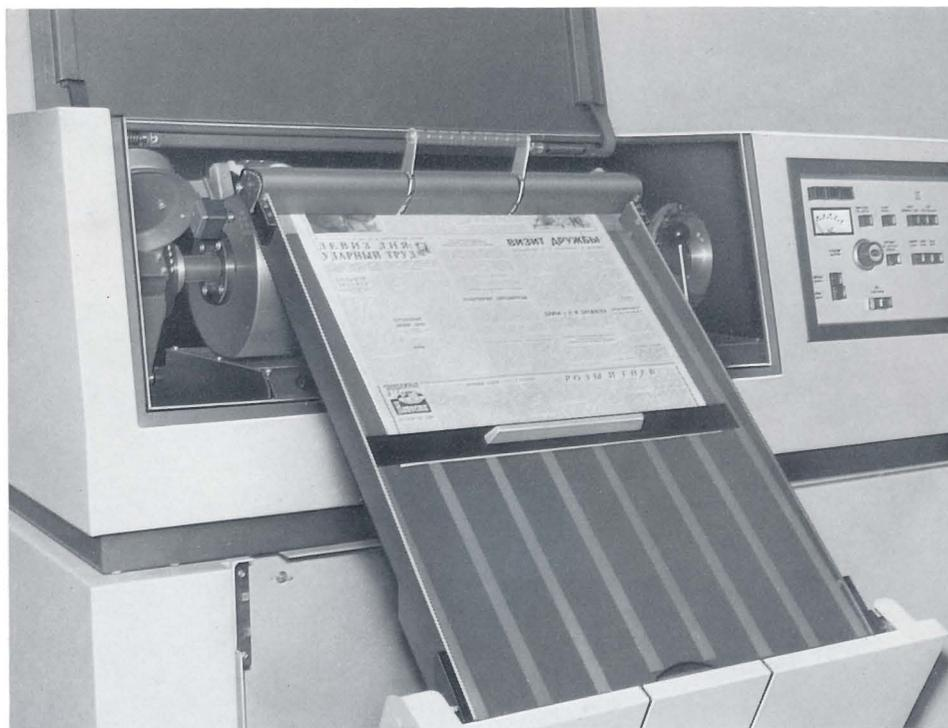
Das Foto zeigt einen Pressfax-Transceiver der dritten Generation, auf dessen Bildwalze gerade ein Zeitungsseiten-Andruck mittels der neuartigen halbautomatisch arbeitenden Aufspannhilfe aufgespannt wird.
