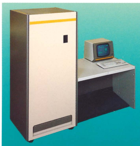
Datenaufbereitung im Image-Processor IP 100, Text/Bild-Integration (gleiches Datenformat wie P 100 K!). Zur filmlosen Pressfax-Seitenübertragung.
