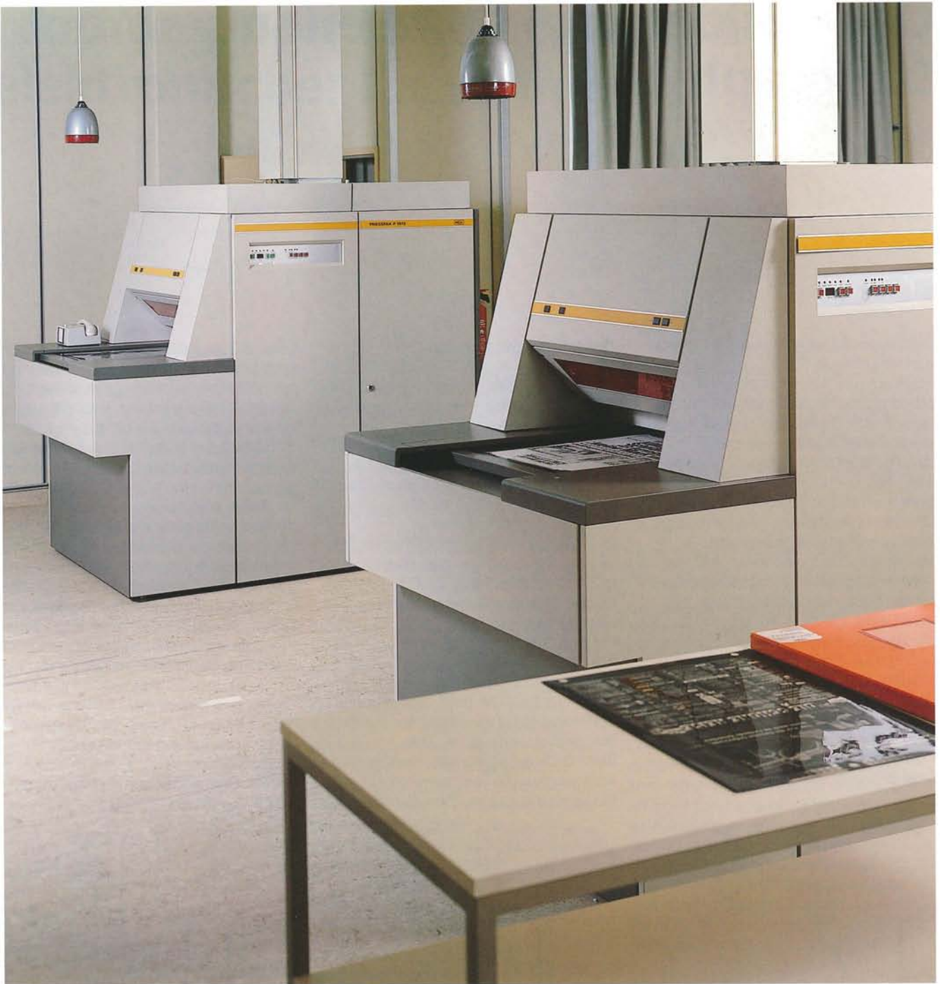
Raum der Empfangsstation. Fünf Press-fax-Recorder werden hier Ende 1984 stehen. Alle mit automatischer Rollfilmzuführung und -übergabe an die in die Wand eingebauten Entwicklungsmaschinen (Pako 24 SQ) ausgestattet.
